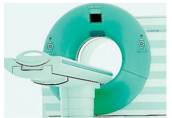
제주대학교병원 종합검진센터에서 운영중인 다중 전산화 단층촬영기는 총 2대이며, 최근 도입한 지멘스사의 듀얼소스 MDCT는 X선을 발생시키는 튜브와 환자를 통과한 X선을 측정하는 검출기가 두개씩 장착돼 기존의 MDCT보다 두배 이상 빨라진 속도와 적은 방사선량으로 더욱 선명한 영상을 얻을 수 있다. 빠른 CT촬영이 필요한 심장질환과 뇌혈관질환, 응급 외상 환자의 영상진단에 큰 도움을 줄 수 있다. (사진 위) 사진=제주대학교병원 제공 심장 전산화 단층 촬영검사는 최근 컴퓨터 단층촬영(CT)이 급속도로 발전함에 따라 지속적으로 움직이는 심장을 짧은 시간 내에 영상화하는 것이 가능해졌다. (사진 왼쪽) 사진=서울대학교병원 의학정보
