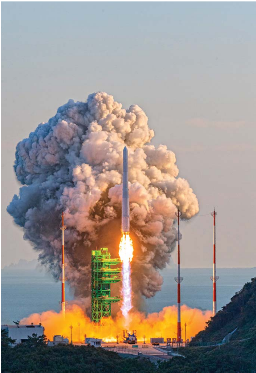
우주로 향하는 누리호 손수 국내 기술로 설계·제작된 한국형 발사체 누리호(KSLV-II)가 21일 전남 고흥군 나로우주센터에서 발사되고 있다. 누리호는 1.5t급 실용위성을 지구 저궤도(600~800km)에 투입하기 위해 만들어진 3단 발사체이며 엔진 설계에서부터 제작, 시험, 발사 운용까지 모두 국내 기술로 완성한 최초의 국산 발사체이다. 연합뉴스
